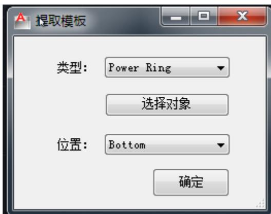
按提示选择对应的 Power Ring 区域，生成的 Power Ring 区域图如下（图中虚线显示区域）
